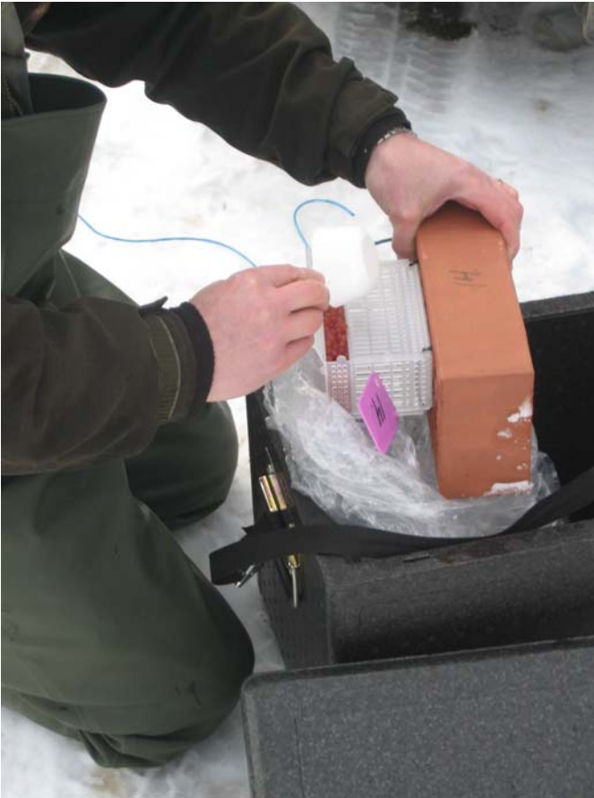
Kuva 6. Mätiä laitettiin 1 dl/rasia Whitlock-Vibert –tyyppiseen mätirasiaan. Rasiat kiinnitettiin reikätiileen, joka piti rasiat paikallaan virrassa.
