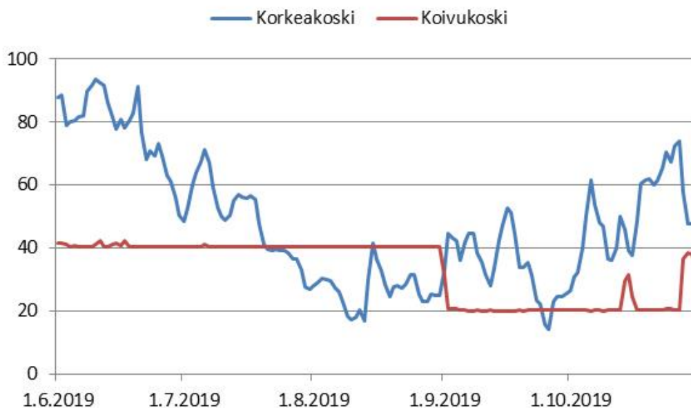
Kuva 9. Korkeakosken ja Koivukosken voimavirtaamat vuoden 2019 seurantakauden aikana.
